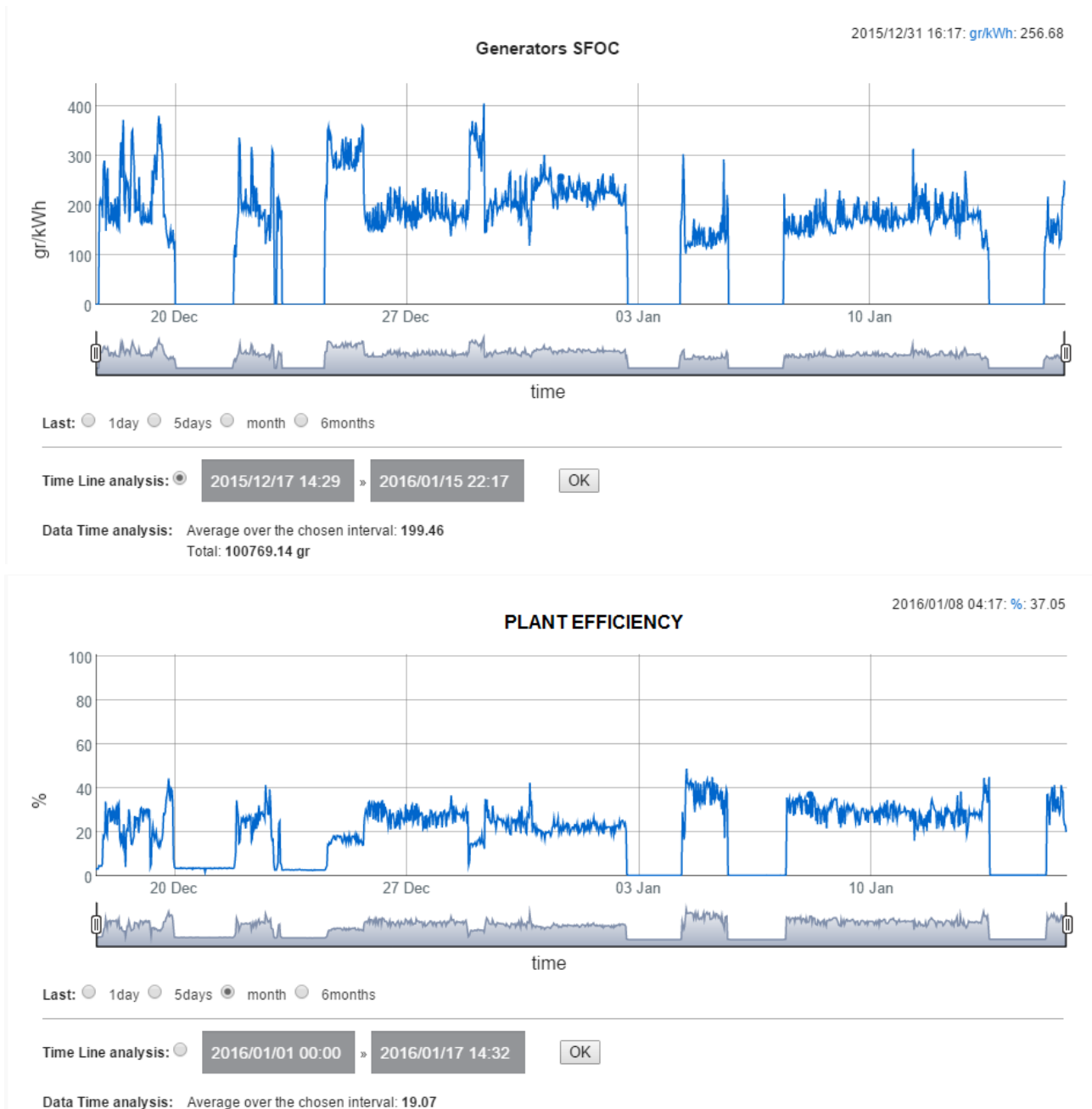
Img. 3 | Software BOEM-S: monitorização do consumo específico e rendimento de uma instalação Diesel ao longo em função do tempo (1 mês).
