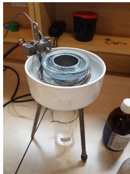
Figura 14 - Montagem para o teste de determinação da viscosidade cinemática a 40°C e 100°C.
