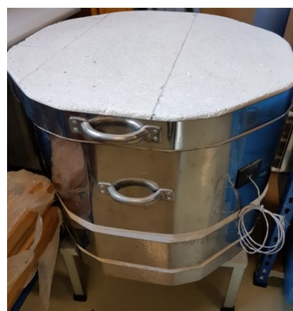
Figura 3 - Determinação do teor de cinzas (mufla)
