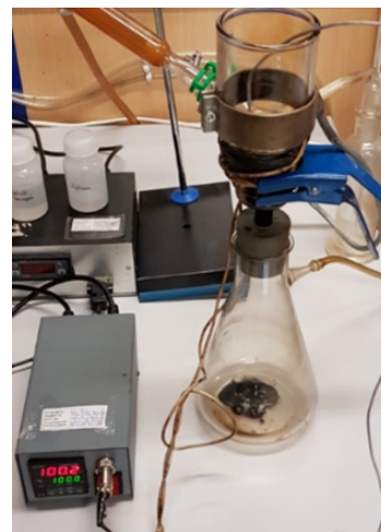
Figura 6 - Material para o teste de determinação do teor de sedimentos totais por filtração a quente.
