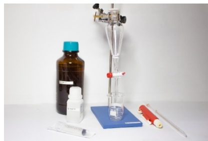
Figura 11 - Material para o teste de Determinação da natureza da água presente na amostra (doce ou salgada).
