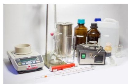
Figura 18 - Material para o teste de determinação do valor ácido e valor base.
