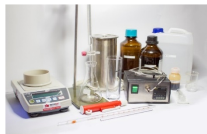
Figura 7 - Material para o teste de determinação do valor ácido e valor base por titulação.
