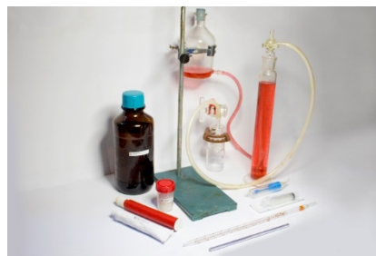
Figura 16 - Material para o teste de determinação do teor de água pelo método de coluna de petróleo.
