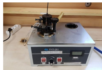
Figura 5 - | Equipamento para determinação do flash point pelo método Pensky-Martens closed cup.
