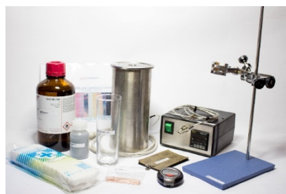
Figura 13 - Material para o teste do Método de ensaio padrão para determinação da corrosão ao cobre de produtos petrolíferos, pelo ensaio da lâmina de cobre.
