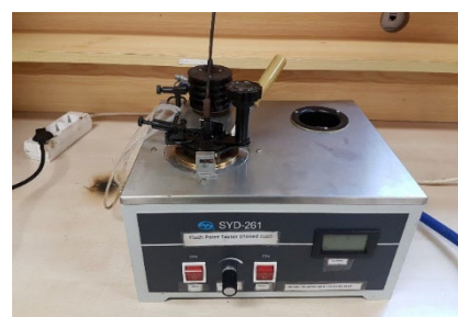
Figura 17 - Equipamento para determinação do flash point pelo método Pensky-Martens closed cup.
