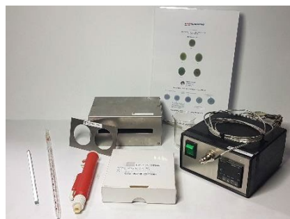
Figura 12 - Material para o teste de Determinação da compatibilidade de misturas de combustível.
