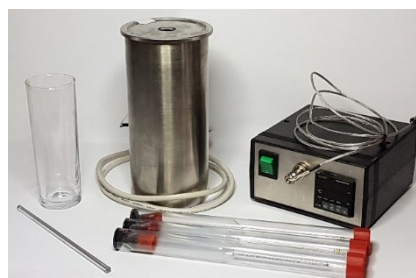
Figura 2 - Material para o teste Determinação da densidade aparente a 15°C.
