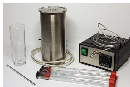
Figura 15 - Material para o teste de determinação da densidade aparente a 15°C.
