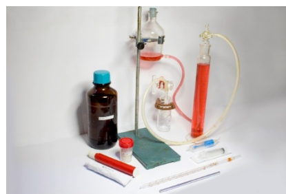
Figura 4 – Material necessário para o teste de determinação do teor de água pelo método de coluna de petróleo.
