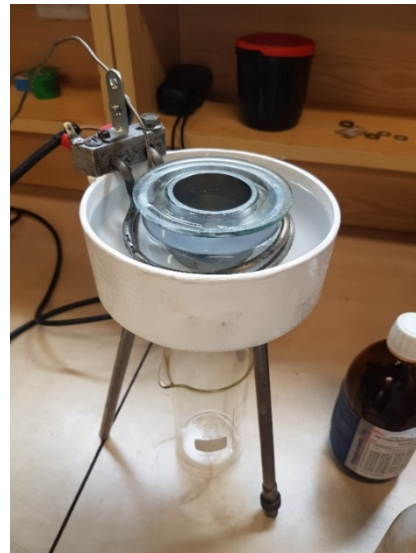
Figura 1 - Montagem para o teste Determinação da viscosidade cinemática a 40°C.
