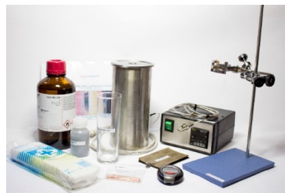
Figura 21 - Material para o Método de ensaio padrão para determinação da corrosão ao cobre de produtos petrolíferos, pelo ensaio da lâmina de cobre.
