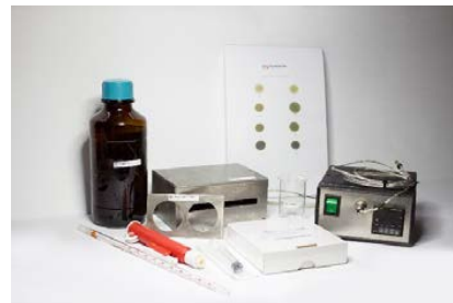
Figura 9 - Material para o teste de Determinação do teor de asfaltenas.
