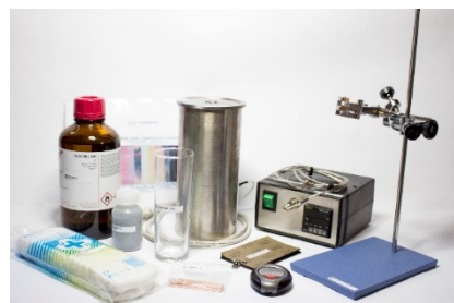
Figura 148 - Material para o Método de ensaio padrão para determinação da corrosão ao cobre de produtos petrolíferos, pelo ensaio da lâmina de cobre.
