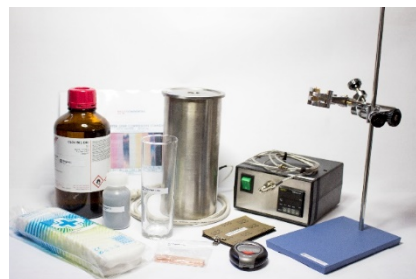
Figura 7 - Material para determinação da corrosividade ao cobre de produtos de petróleo pelo teste de tiras de cobre.
