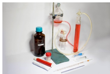
Figura 114 - Material para o teste de determinação do teor de água pelo método de coluna de petróleo.
