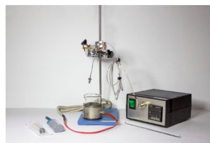
Figura 6 - Material para o teste de determinação do flash point e fire point em copo aberto.
